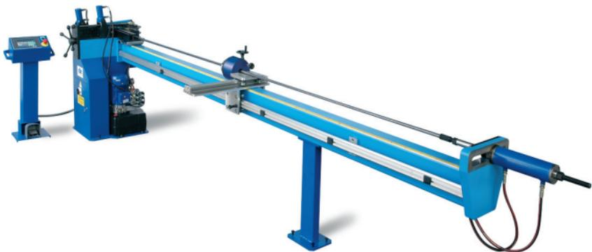
UNI 70/HC-OS digitale, una curvatubi potente e precisa per curvare tubi di grande diametro, e **con il kit per curvare con anima** e oscillante anche tubi delicati e sottili; i raggi di curvatura ottimali e costanti non deformano in alcun modo i tubi curvati: ideale per le varie esigenze degli operatori nei settori dell'idraulica, nautica, oleodinamica, industria e impiantistica in genere. Capacità massima di curvatura diam. 50 e diam. 1"1/2 gas.
