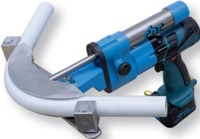
Curvatubi idraulica a batteria 12 V per curvare tubi in rame ricotto fino al Ø 22 spessore tubo 1,5 mm e multistrato fino al Ø 32 spessore tubo 3 mm.
