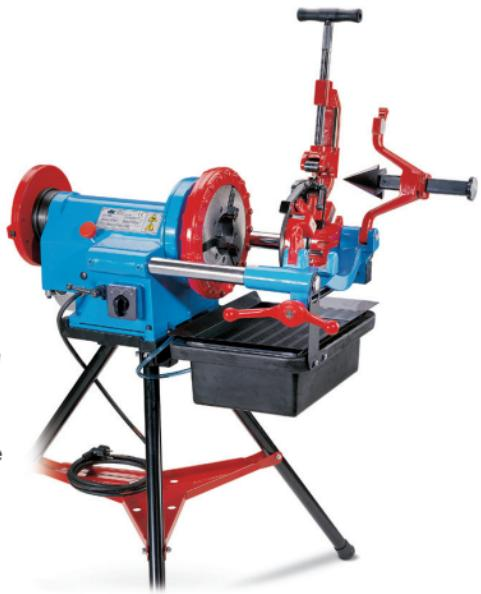
Roscadora eléctrica con mandril portapeines de apertura automática para roscar de  $1/4''$  a  $3''$  (con motor a inducción), con posibilidad de roscar hasta  $4''$  con el adaptador mod. 97.
