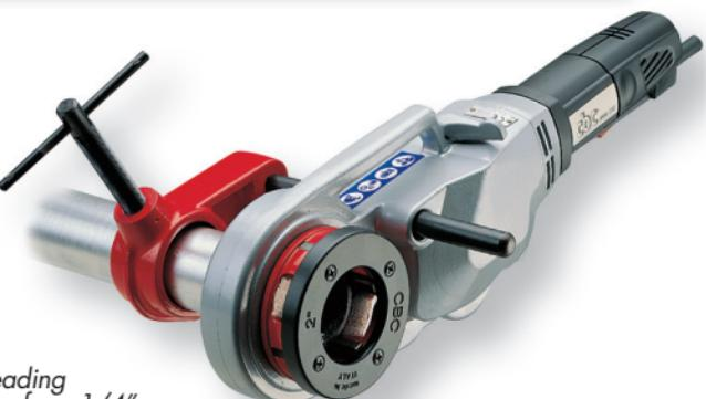
Roscadora eléctrica portátil para roscar de 1/4" a 2" y con la posibilidad de roscar hasta 4" con el adaptador mod.97.
